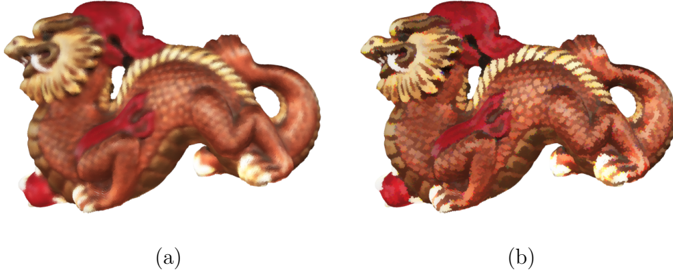
FIGURE 4.6 – Filtre de choc sur un nuage de point 3D avec p = 2 . Le graphe est construit comme un k -ppv spatial. La figure (b) présente le résultat en utilisant w(u, v) = 1 et k = 10 .
