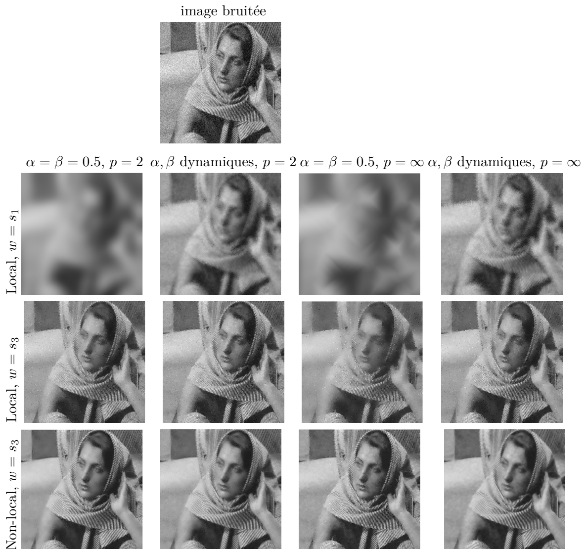
FIGURE 4.2 – Illustration du comportement du p -Laplacien avec termes de gradients pour le filtrage d'image. Les trois lignes représentent différentes constructions de graphes : 4-connexité avec w = s_1 pour la première, w = s_3 pour la deuxième en utilisant la similarité couleur et un k -ppv en utilisant la similarité entre patchs pour la troisième. La première et la troisième colonne montrent le comportement du filtrage avec \alpha = \beta = 0.5 , ce qui correspond au p -Laplacien anisotrope sur graphe. La seconde et la quatrième colonne montrent l'utilisation des fonctions \alpha et \beta adaptatives, en utilisant la courbure moyenne d'une fonction sur graphe. Voir le texte pour plus de détails.
