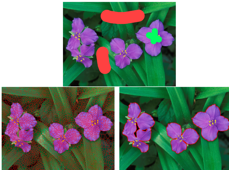
FIGURE 4.10 – Segmentation interactive d'une image en utilisant un graphe d'adjacence de régions, étendue avec des arêtes additionnelles, afin de connecter les régions similaires au sens de la couleur. Cette construction permet de diffuser les germes initiaux à travers des objets non connectés spatialement ( e.g. les fleurs dans cette image).
